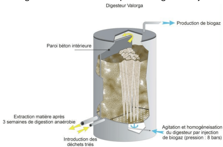
Figure 62 : Schéma du fonctionnement d'un digesteur pneumatique
